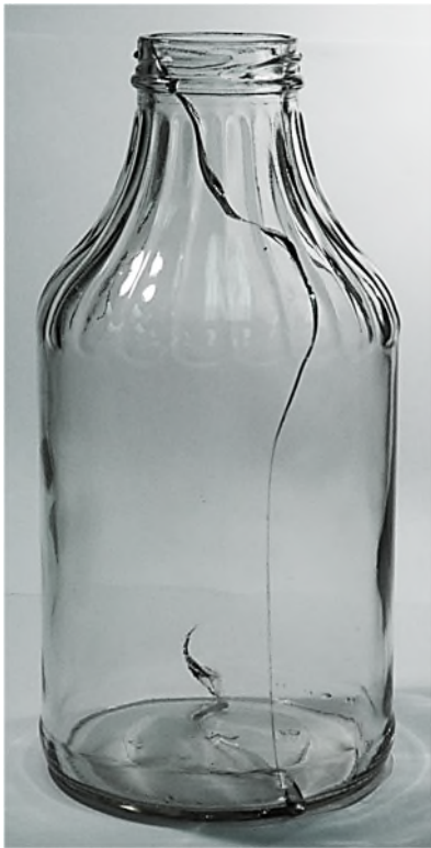
H1 Thermal Shock Heel Origin
